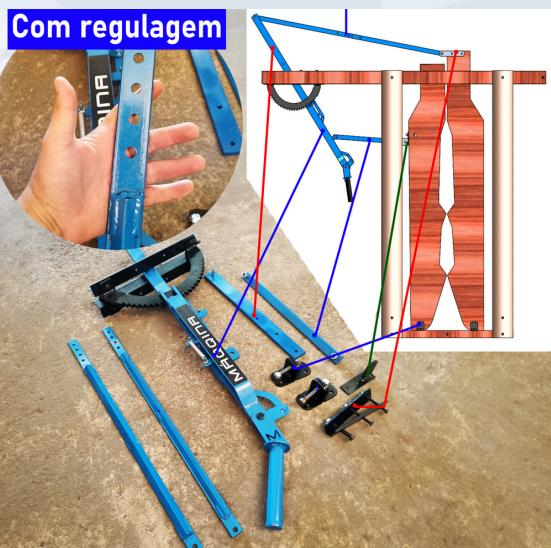
Possui regulagens nas hastes de força, que permite o material se adaptar a qualquer projeto
